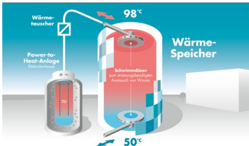
01 Schematische Darstellung des PtH-Speichers der Stadtwerke Rostock
